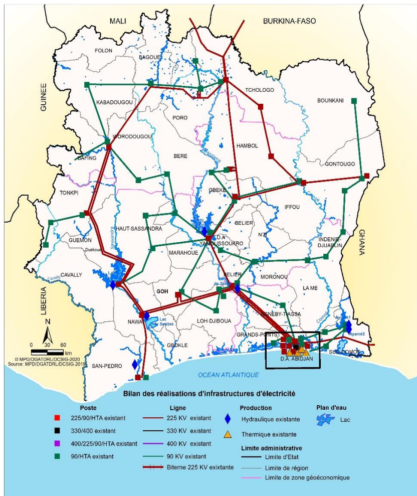
Carte 123: Bilan de réalisation en infrastructures d'électricité
